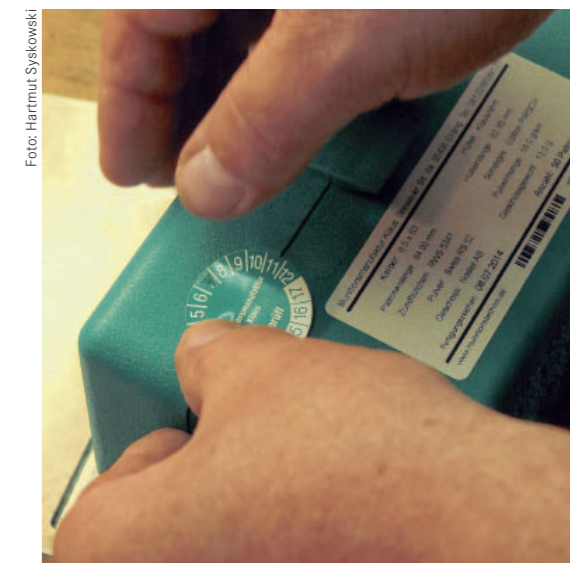
Ein Herstellungszeichen weist das Produktionsdatum aus. Es folgt ein behördliches C.I.P.-Siegel.
